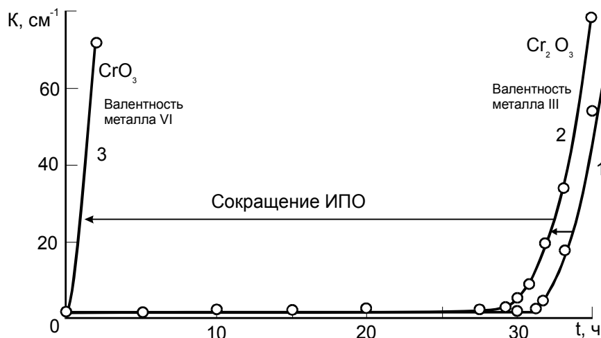
Рисунок 1 – Изменение коэффициента экстинкции полосы поглощения 1720\text{ см}^{-1} при окислении образцов полиэтиленовых пленок, содержащих 0,1 % ирганокса 1010 (1–3) и 1 % \text{Cr}_2\text{O}_3 (2), 1 % \text{CrO}_3 (3) (толщина пленок 100 мкм, температура окисления 150\text{ }^\circ\text{C} )
