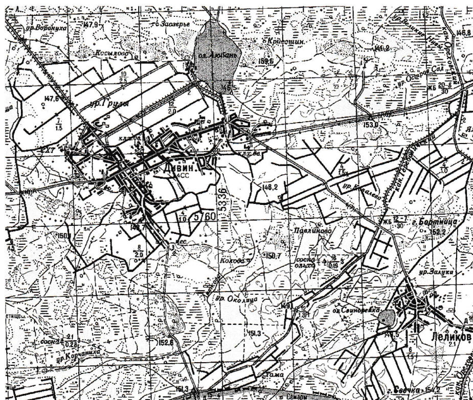
Рис. 1. Замена первоначального водотока 1-го порядка мелиоративной системой (на примере р. Литкова, Кобринский район)
