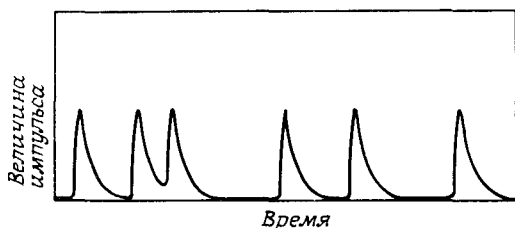
Рис. 1.4. Дробовой шум: идентичные электрические импульсы, приходящие случайно по времени.
