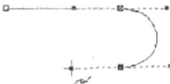
5. Четвертый узел строится точно так же, как третий (рис. , слева). Теперь кривую следует замкнуть. Для этого указатель мыши перемещается на начальную точку (до появления в качестве указателя мыши «стрелочки» вместо символического изображения узла) и нажимается левая кнопка мыши. Остается только перетащить направляющую точку вправо при нажатой клавише Ctrl (чтобы левое закругление стало симметричным), и замкнутая кривая будет построена (рис., справа).
